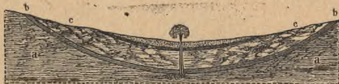
Rys. 4. Obrazowe przedstawienie studni artezyskiej: a) podłoże nieprzepuszczalne, b) warstwa wodonośna, c) nieprzepuszczalna.
