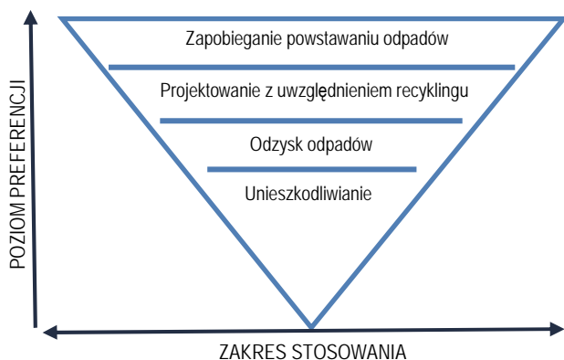
Rysunek 1. Hierarchia działań związanych z zagospodarowaniem odpadów (oprac. na podstawie Biegańska i Ciuła, 2011)
