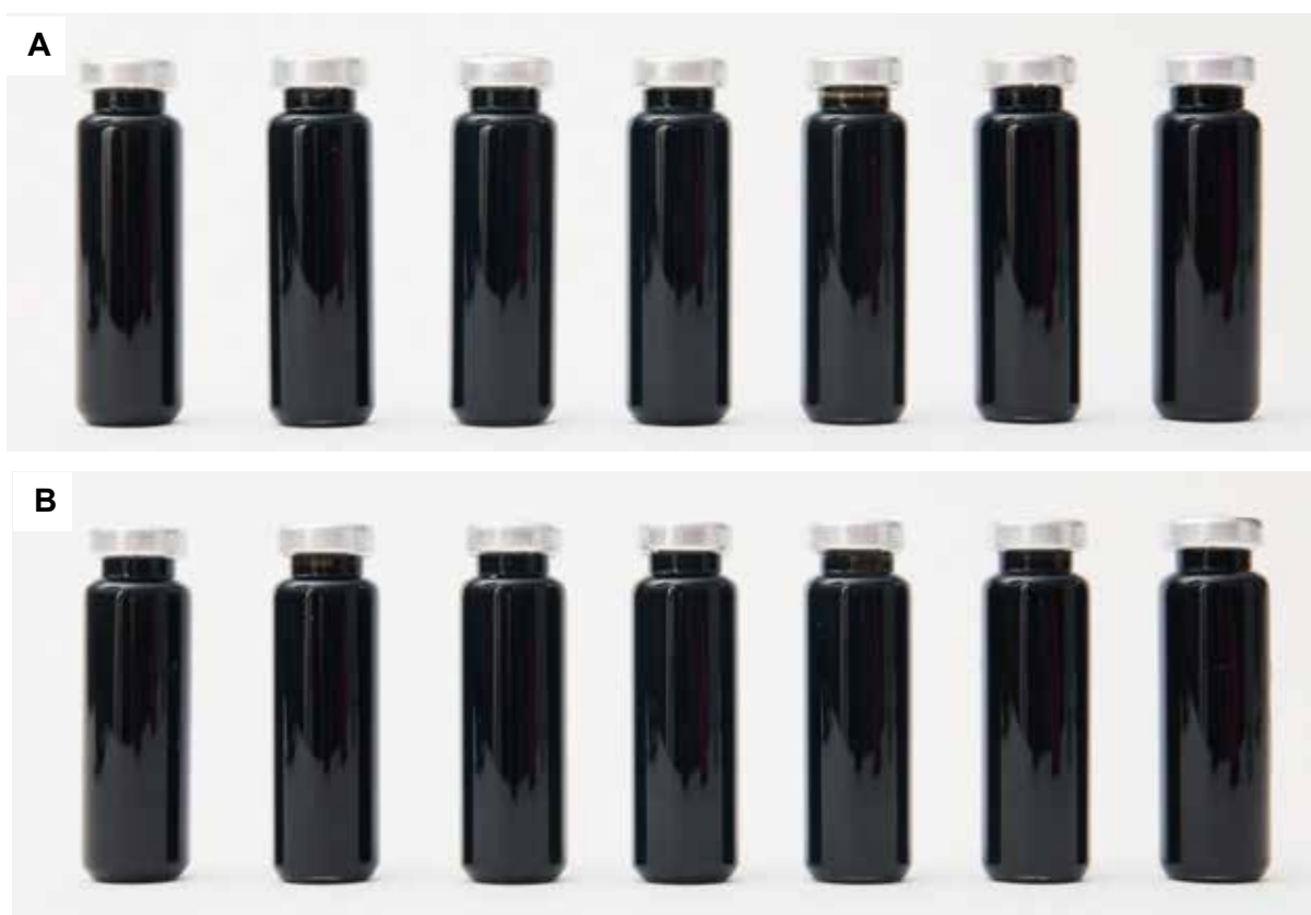
Rysunek nr 33 Zdjęcia przykładowych nanofluidów po badaniu stabilności sedymentacyjnej w temperaturze 297 K bez postępu do światła słonecznego A – (od lewej) MEG+2,00% mas. k-MWCNTs – po 22 miesiącach, MPG+2,00% mas. k-MWCNTs – po 48 miesiącach, PDO+2,00% mas. k-MWCNTs – po 48 miesiącach, G+2,00% mas. k-MWCNTs – po 22 miesiącach, MEG-G+2,00% mas. k-MWCNTs – po 21 miesiącach, MPG-G+2,00% mas. k-MWCNTs – po 23 miesiącach, PDO-G+2,00% mas. k-MWCNTs – po 23 miesiącach; B – (od lewej) MEG+1,00% mas. d-MWCNTs – po 40 miesiącach, MPG+2,00% mas. k-MWCNTs – po 22 miesiącach, PDO+2,00% mas. k-MWCNTs – po 22 miesiącach, G+2,00% mas. k-MWCNTs – po 22 miesiącach, MEG-G+2,00% mas. k-MWCNTs – po 21 miesiącach, MPG-G+2,00% mas. k-MWCNTs – po 22 miesiącach, PDO-G+2,00% mas. k-MWCNTs – po 22 miesiącach
