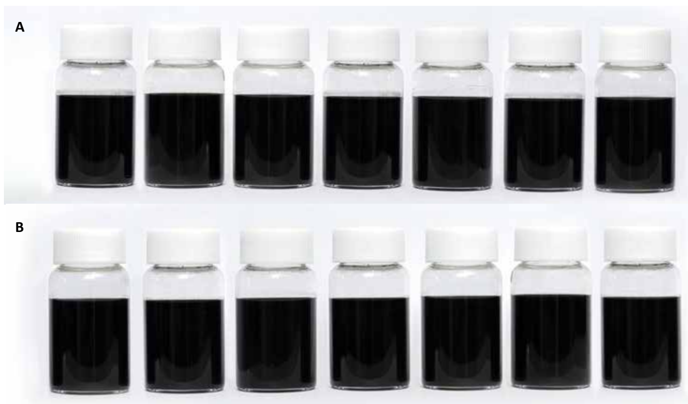
Rysunek nr 20 Zdjęcia nanofluidów zawierających 2,00% mas. k-MWCNTs (A) i 1,00% mas. d-MWCNTs (B) na bazie (od lewej) MEG, MPG, PDO, G, MEG-G, MPG-G, PDO-G
