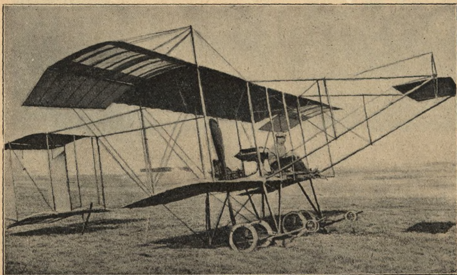
(Ryc. 26). Dwupłatowiec Henryka Farmann'a po usunięciu ścian bocznych z obrotym sterem wysokości na przodzie.
