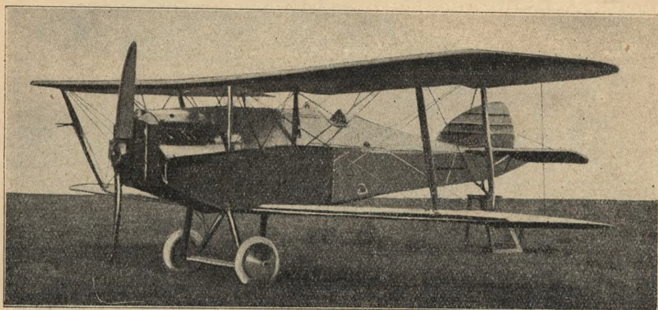
(Ryc. 103). Dwupłatowy pościgowiec angielski Martinsyde F 3, o 250 MK. silniku Rolls-Royce, najnowszej konstrukcji, (prędkość w locie 230 km./godz.).
