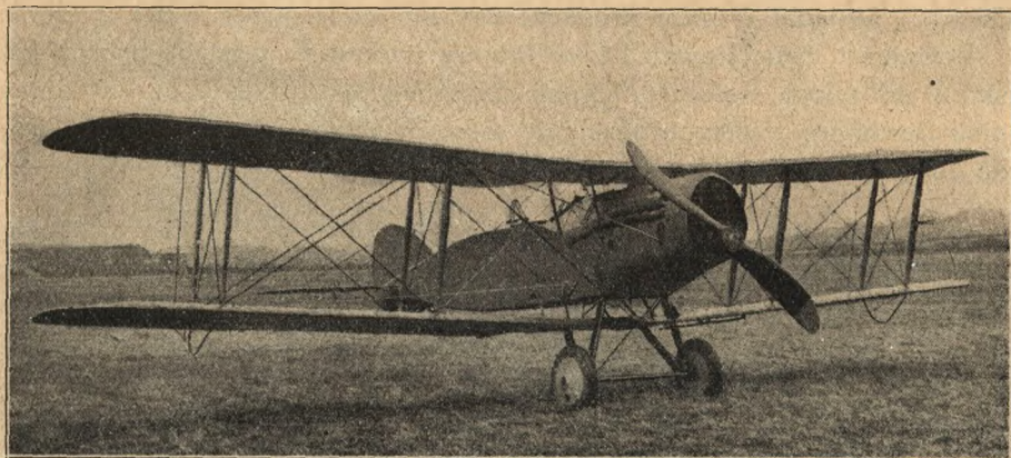
(Ryc. 118). Wywiadowczy dwupłatowiec Bristol-Fighter typu F2 o 300 MK. silniku Hispano-Suisa.
