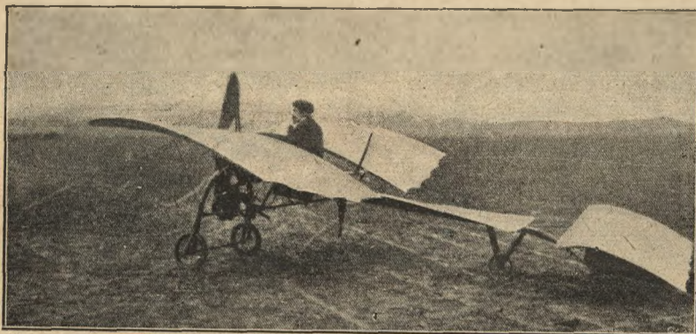
(Ryc. 219). Jednopłatowiec Vendôme uproszczonej konstrukcji. (Patrz str. 79).
