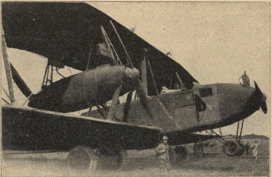
(Ryc. 133). Dwa silniki prawej gondoli i jeden środkowy w kadłubie olbrzymia R 69.
