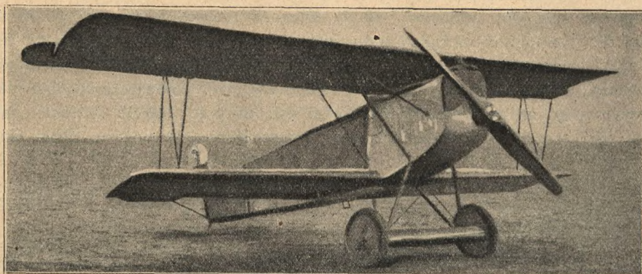
(Ryc. 97). Dwupłdowy pościgowiec Fokker D VII.
