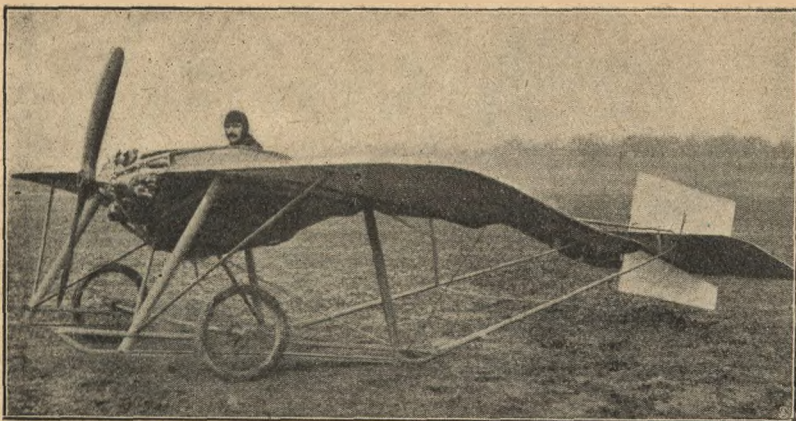
(Ryc. 218). Jednopłatowiec Nieuport pierwszej konstrukcji o ciężarze 260 kg. i 12 m. powierzchni. (Patrz str. 78).
