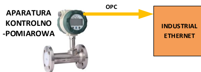
Rys. 8.39. Podłączenie urządzenia z własnym serwerem OPC
