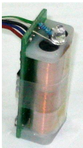
Rys. 7.39. Widok nadajnika lokacyjnego systemu GLON (przed hermetyzacją) oraz jego schemat ideowy
