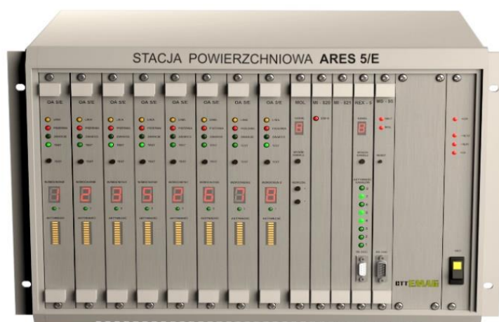
Rys. 12.9. Stacja powierzchniowa systemu ARES 5/E
