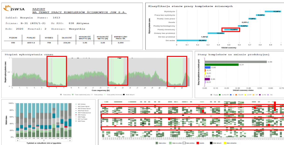
Rys. 3.55. Przykładowy raport kwartalny prowadzenia ściany B-31 w KWK Borynia z wyraźnie zaznaczoną pracą kompleksu oraz przerwą międzymianową związaną z obstrzeniami metanowymi (ściana B-31 obkładana była w systemie trzymianowym)
