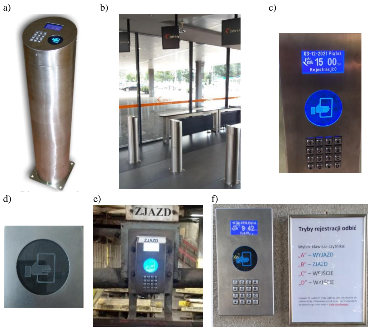
Rys. 7.7. Czytniki ZAM A.70: a) w obudowie przykręcanej do podłoża, b) w układzie szeregowym na głównej bramie wejściowej kopalni, c) widok płyty czołowej, d) czytnik w wersji terminalowej, e) czytnik na nadszybiu szybu zjazdowego - ewidencja zjazdów, f) w obudowie przykręcanej do ściany przy szybie peryferyjnym realizującym zarówno funkcje RCP, jak i rejestrującym zjazd do wyrobisk podziemnych
