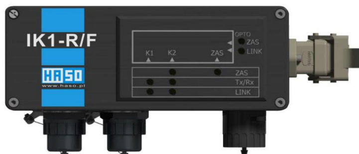
Rys. 6.24. Widok iskrobezpiecznego konwertera mediów typu IK1-R/F firmy HASO z przyłączem hybrydowym (dla Fo i Cu z boku urządzenia), oznakowanie I M1 Ex ia op is I Ma [HASO]
