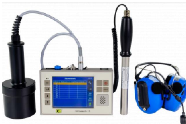
Rys. 7.40. Widok odbiornika lokacyjnego MinSearch-15 z anteną, szperaczem i słuchawkami
