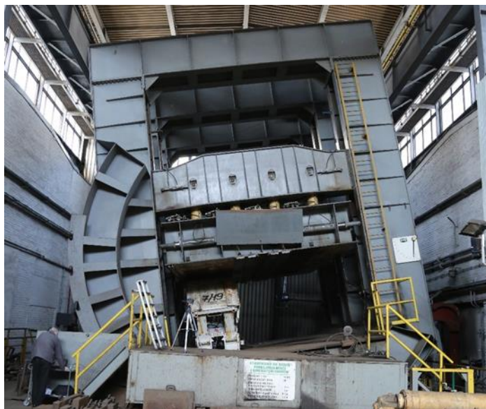
Rys. 9.31. Sekcja obudowy zmechanizowanej w stanowisku obrotowym – testy systemu SSMS
