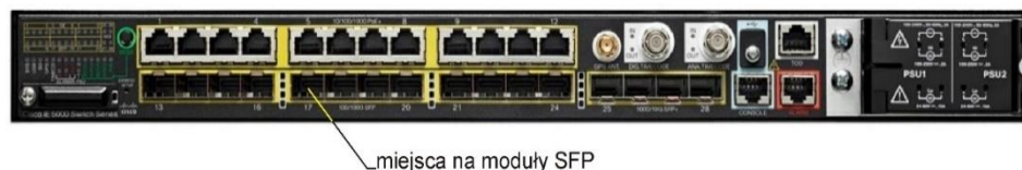
Rys. 6.32. Widok przełącznika z serii IE-5000 z zaznaczeniem rozmieszczenia modułów SFP
