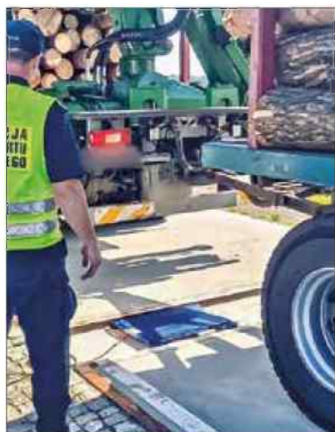
Dynamiczny pomiar obciążenia - pojazd przejeżdża przez specjalną wagę
