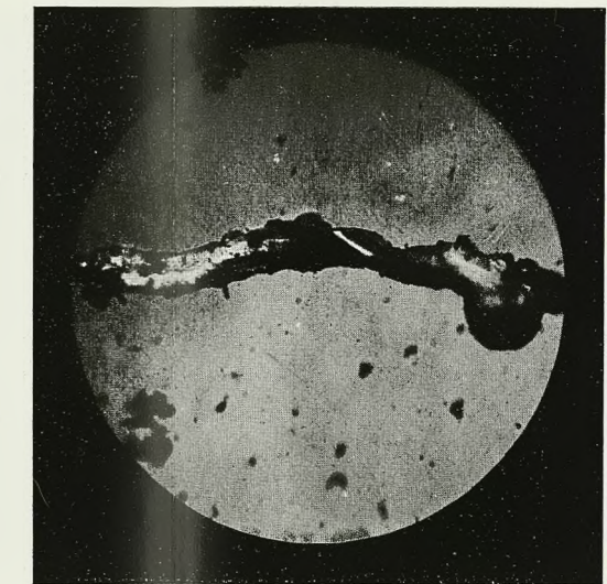
Abbildung 17. Werkzeugstahl, weich. Abschliff in 1 Stunde 870 g; enthielt Metall 793 g und Schleifmittel 87 g.
