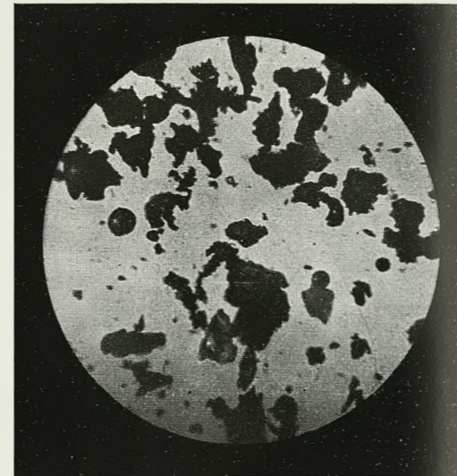
Abbildung 19. Hartguß. Abschliff in 1 Stunde 625 g; enthielt Metall 597 g und Schleifmittel 28 g.
