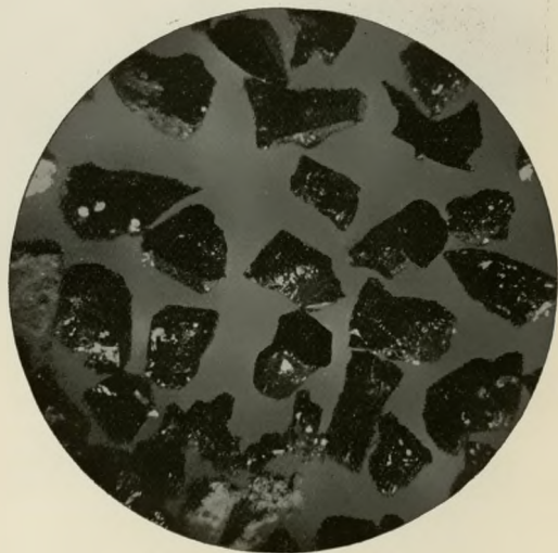
Abbildung 4. Karbosilite aus dem elektrischen Ofen, Erzeugnis aus Koks und Sand.
