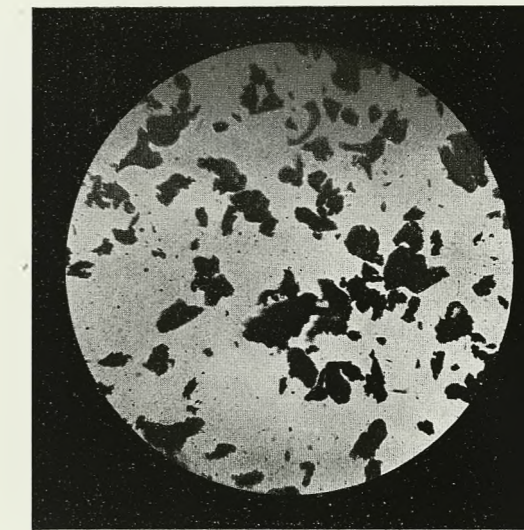
Abbildung 16. Grauguß. Abschliff in 1 Stunde 460 g; enthielt Metall 448 g und Schleifmittel 12 g.
