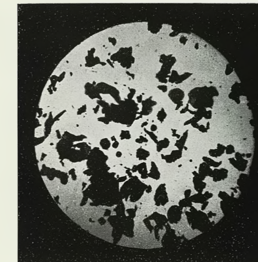
Abbildung 24. Grauguß. Abschliff in 1 Stunde 850 g; enthielt Metall 833 g und Schleifmittel 17 g.
