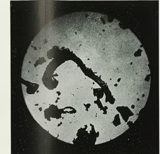
Abbildung 25. Werkzeugstahl, weich. Abschliff in 1 Stunde 750 g; enthielt Metall 735 g und Schleifmittel 15 g.
