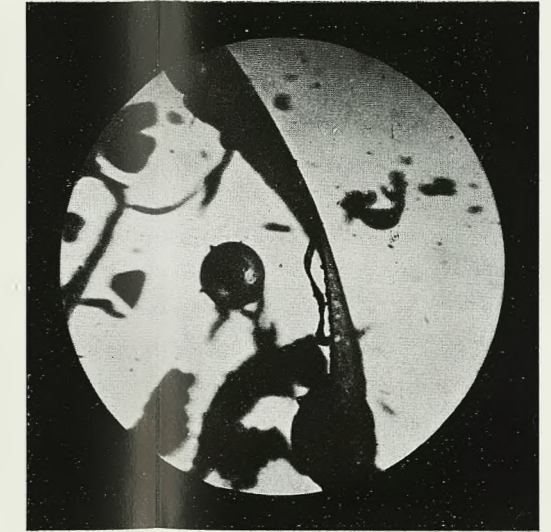
Abbildung 21. Werkzeugstahl, weich. Abschliff in 1 Stunde 1050 g; enthielt Metall 1029 g und Schleifmittel 21 g.
