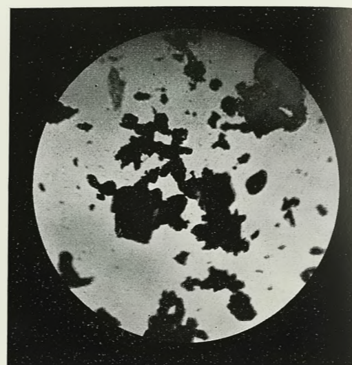
Abbildung 23. Hartguß. Abschliff in 1 Stunde 990 g; enthielt Metall 950 g und Schleifmittel 40 g.
