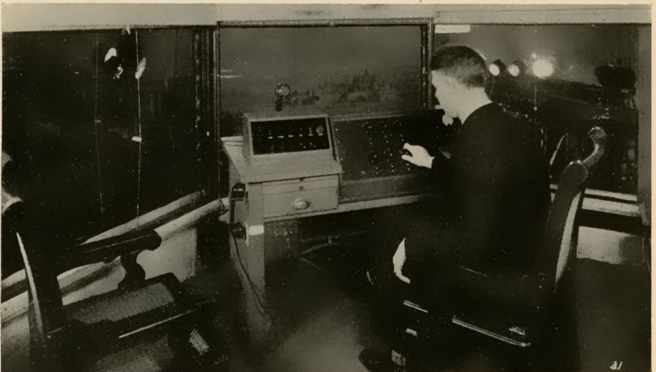
In der Kabine des „Mixers“, der alles, was das Mikrophon aufnimmt, überprüft und die Lautstärken regelt
