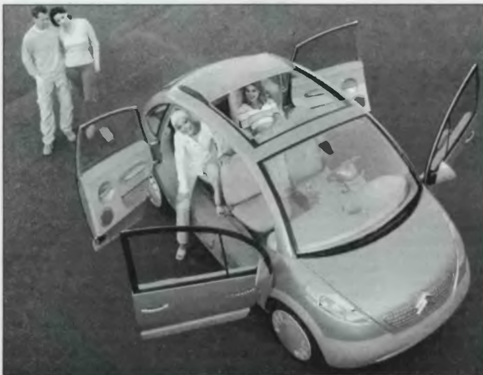
Przednie drzwi citroena C3 otwierają się do przodu, tylne – do tyłu.
