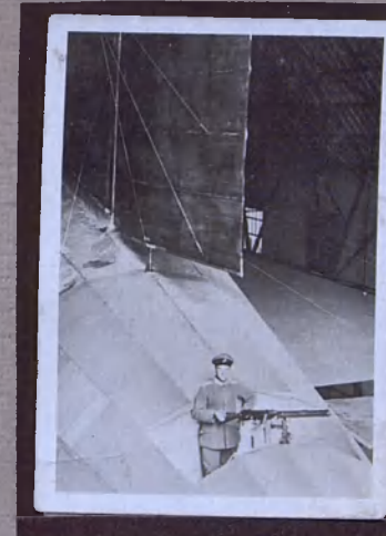
Bild Nr. 50: Heck-Maschinengewehrstand eines Armeeluftschiffs
