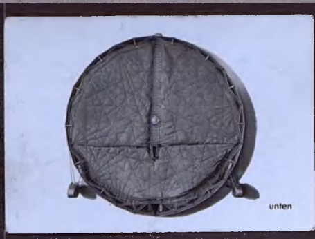
Bild Nr. 84: Querschnitt des »Graf Zeppelin«
