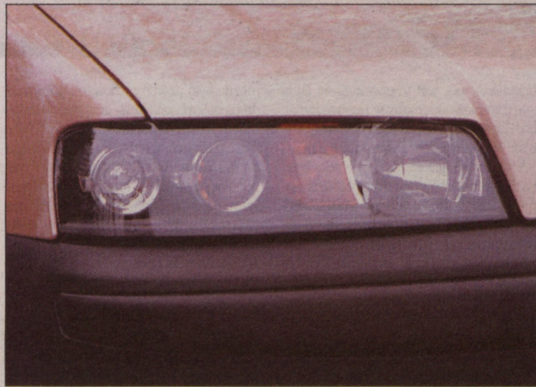
Reflektory mają przezroczyste szyby i umieszczone pośrodku kierunkowskazy.
