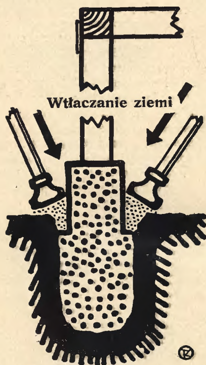
Betonowanie pali. III.
