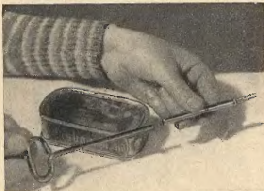
Specjalna wkładka do klucza do otwierania puszek, zakończona widelczykiem, otwiera łatwo i czysto wszystkie puszk.
