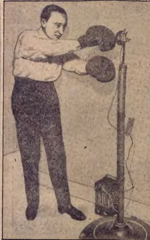
Aparat, sprawdzający celność ciosów bokserskich z zapisywaczem.
