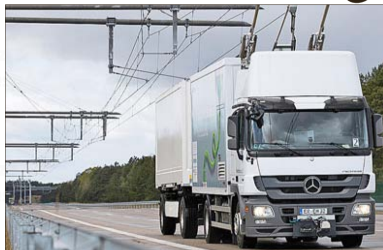
Eine Autobahn-Teststrecke in Hessen für strombetriebene Lkws
