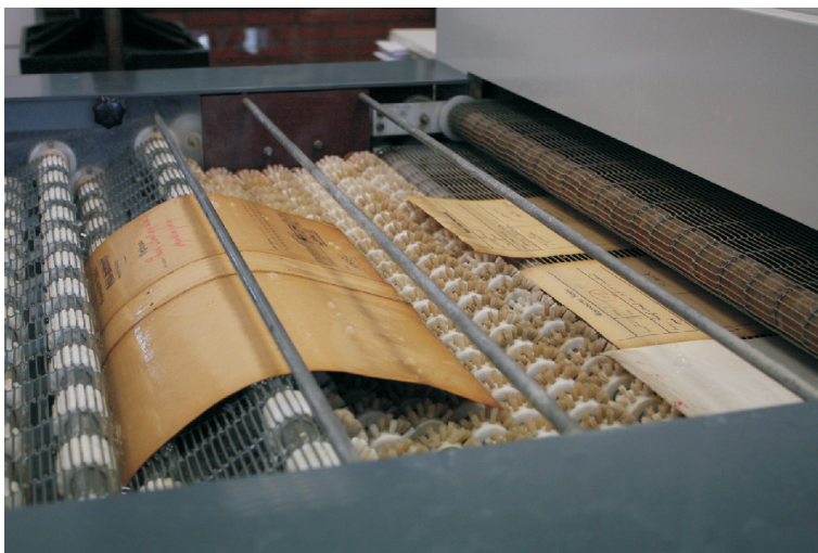
Fot. 3. Archiwalia w trakcie kąpieli odkwaszającej w maszynie C900 firmy Neschen (fot. Ewelina Kisiel)
