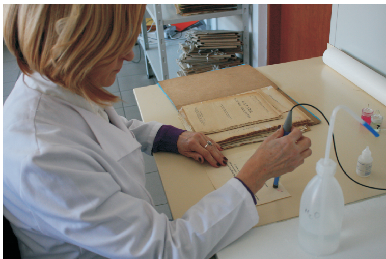
Fot. 2. Badanie pH papieru metodą kontaktową przy użyciu pH-metru firmy Mettler Toledo (fot. Ewelina Kisiel)
