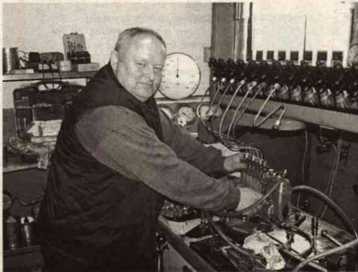
Henryk Dąbrowski przy specjalistycznym stanowisku do sprawdzania pomp wtryskowych
