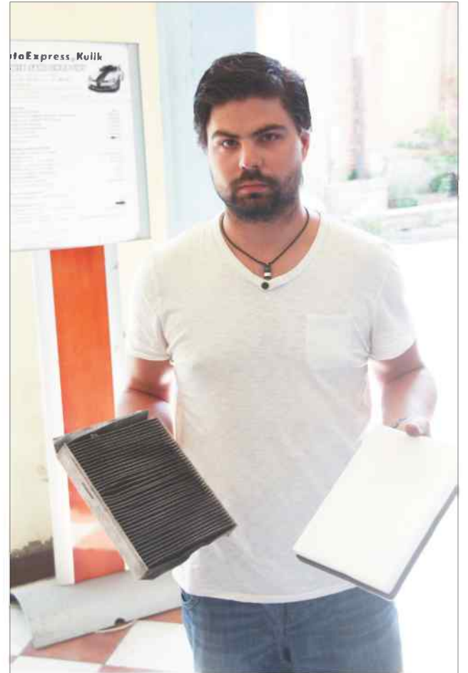
Robert Stabryło z firmy AutoExpress Kulik prezentuje zużyty i nowy filtr pyłkowy. Wymiana filtra pyłkowego powinna odbywać się co roku wraz z serwisem klimatyzacji.
