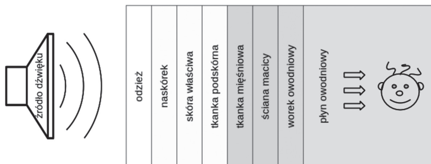
Rys. 1. Schemat kolejnych warstw tłumiących dźwięk na drodze od źródła do ucha płodu
