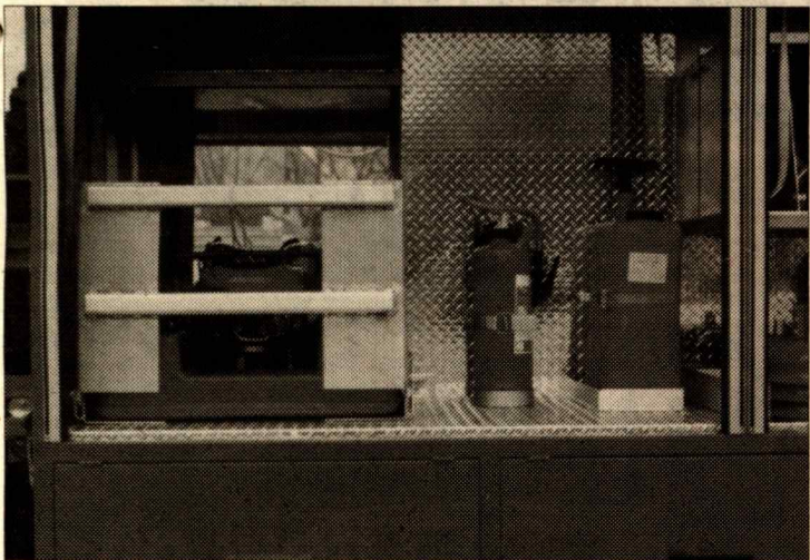
Pompa pływająca może pobierać wodę z płytkich i małych zbiorników
