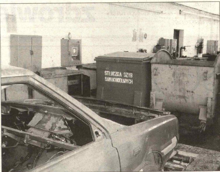
Pojazd jest rozbierany na części, które są segregowane w odpowiednich pojemnikach
