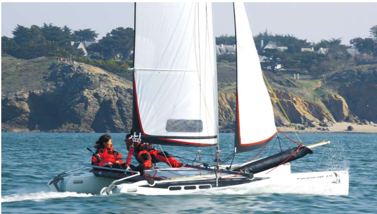
Płetwy sterowe można podnosić i opuszczać automatycznie, wystarczy zdecydowany ruch rumplą do góry.
