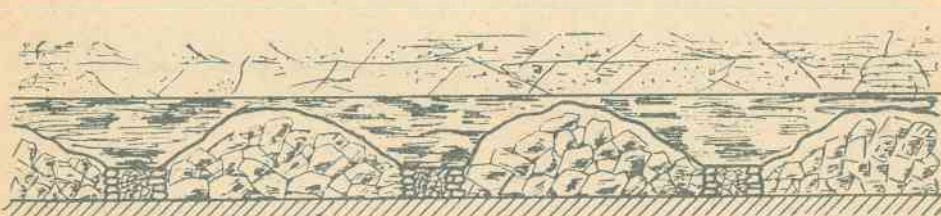
Rys. 50. Częściowy zawal stropu przy wykorzystaniu dla podsadzki skały z zawalu
