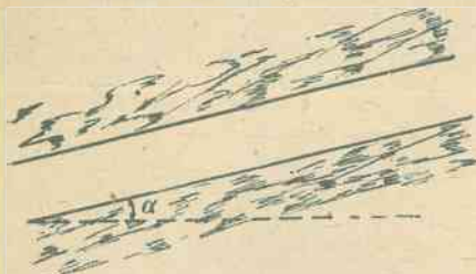
Rys. 42. Chodnik prowadzony równoległe do ułatwienia
