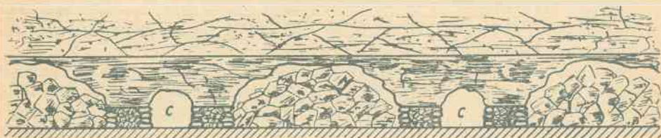
Rys. 49. Częściowy zawal stropu między pasami podsadzki otrzymanej z przybierki specjalnych chodników c
