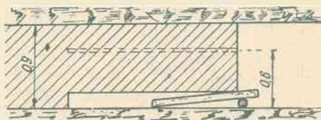
Rys. 127. Umieszczenie klocków we wrębie
