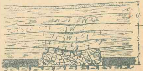
Rys. 27. Zachowanie się skał stropowych przy eksploatacji z zawalem
