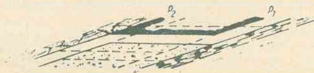
Rys. 221. Uniknięcie potrzeby prowadzenia chodników warstwowych
