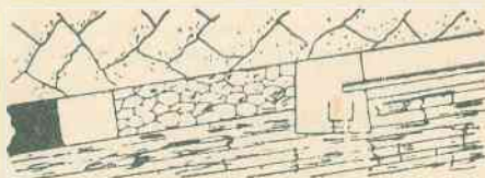
Rys. 132. Ładowanie urobku pod ścianą z przenośnika do wozów
