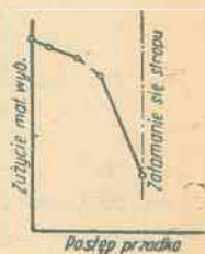
Rys. 20. Zużycie materiału wybuchowego przy okresowym załamaniu się stropu (Urban)
