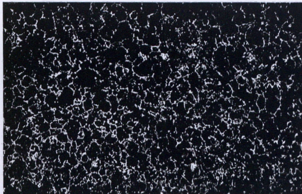
Rys. 13. Wielkość ziarn stali zmienionej, przekutej na 30 kwadrat.
