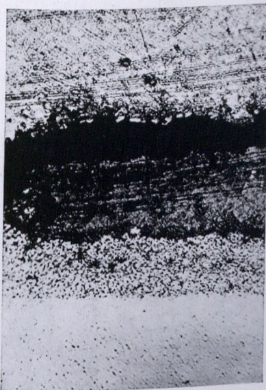
Rys. 7. Rozłożenie warstw tlenków w zgorzelinie stali MR.
