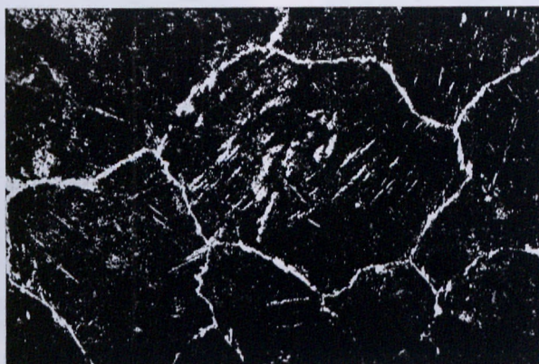
Rys. 17. Pierwotne ziarna austenitu z wlewków stali chłodzonych w czasie krzepnięcia z szybkością: a — 16^{\circ} C/min., b — 6,7^{\circ} C/min., c — 4,4^{\circ} C/min. (traw. kwasem pikr.) \times 100 .
