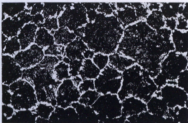
Rys. 33. Wielkość ziarn stali niezmięionej, przewalcowa- nej na pręt \varnothing = 20 mm.
