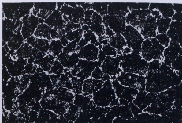
Rys. 60. Wielkość ziarn stali niezmienionej, przekutej na 10 kwadrat (zgląd podłużny).
