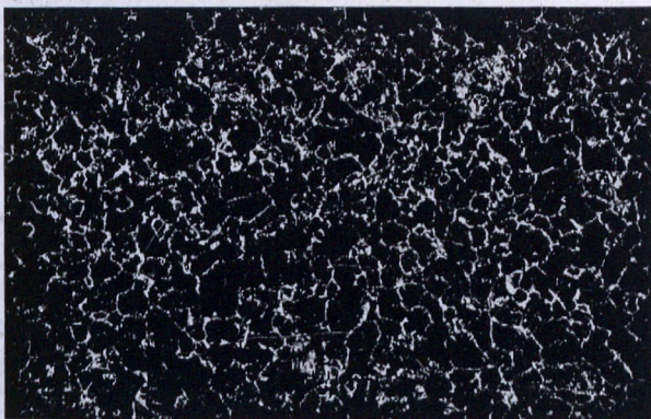
Rys. 10. Wielkość ziarn stali zmienionej, przekutej na 100 kwadrat.
