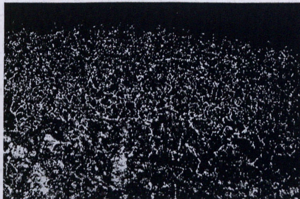
Rys. 14. Wielkość ziarn stali zmienionej, przekutej na 10 kwadrat.
