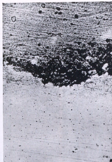
Rys. 10. Rozłożenie warstw tlenków w zgorzelinie stali KNS12
