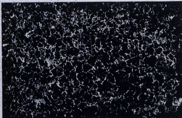
Rys. 11. Wielkość ziarn stali zmienionej, przekutej na 60 kwadrat.
