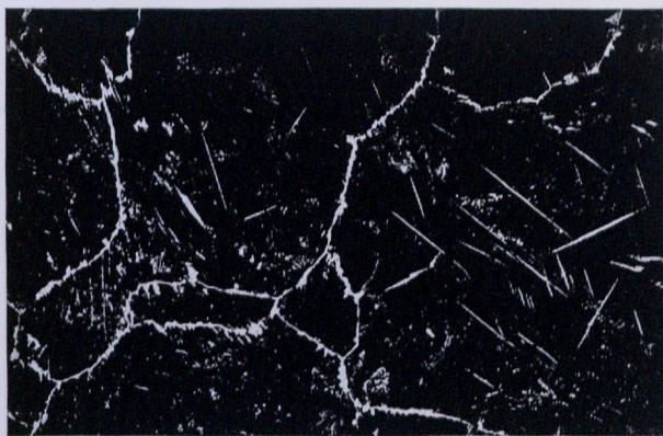
Rys. 23. Wielkość ziarn stali niezmienionej, przewalcowanej na 95 kwadrat (przed walcowaniem stal długo trzymano w piecu).
