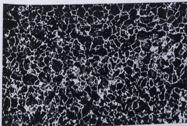
Rys. 58. Wielkość ziarn stali zmienionej, grzanej 4 h w 1000° C.
