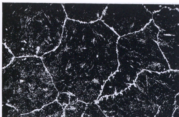
Rys. 24. Wielkość ziarn stali niezmienionej, przewalcowanej na 65 kwadrat.
