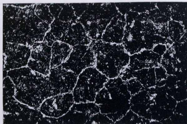
Rys. 26. Wielkość ziarn stali niezmienionej, przewalcowanej na 16 kwadrat.
