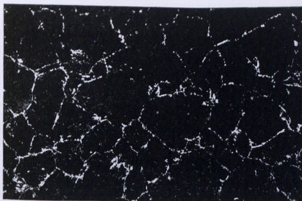
Rys. 16. Wielkość ziarn stali niezmięnionej, przekutej z kęsa 50 kwadrat, ponownie nagrzanego na 20 kwadrat.
