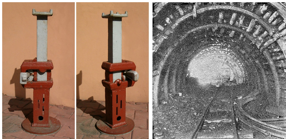
54. Stojak stalowo członowy „Gerlach”, oraz obudowa wyrobiska korytarzowego z łuków podatnych.
