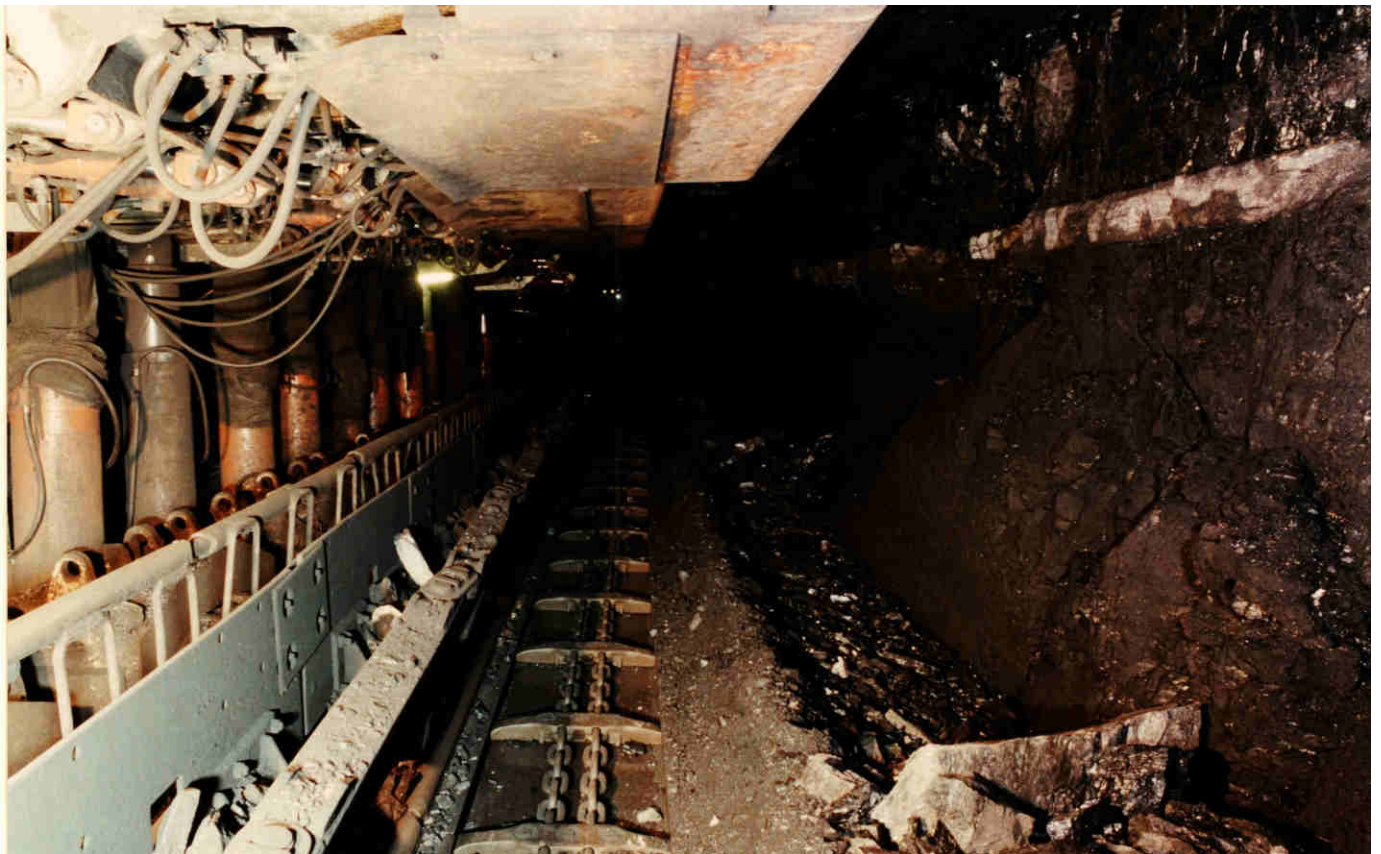
Na wprost przenośnik ścianowy Rybnik, po prawej calizna węgla przygotowana do urabiania. Z lewej obudowa zmechanizowana Fazos.
