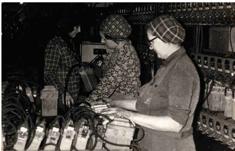
Lampownia. Systematyczny i dokładny przegląd stanu lamp górniczych gwarantował pełną ich sprawność.
