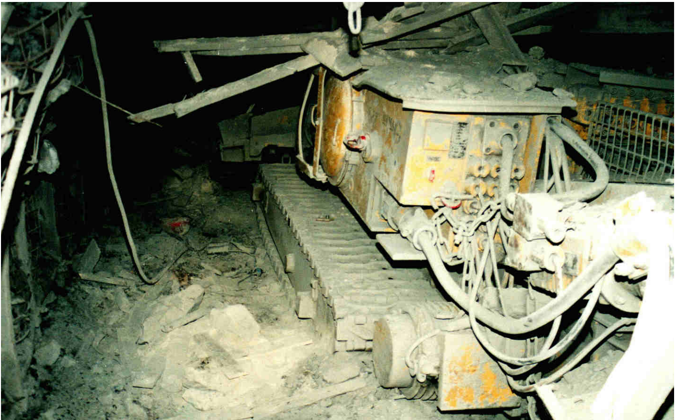
Na zdjęciach skutki tąpnięcia górotworu.
