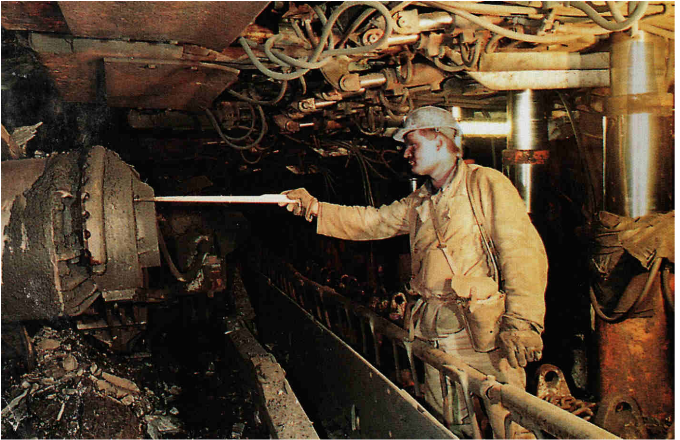
Sztygar oddziałowy Ludwik Kuźnik przy kombajnie ścianowym KSW. Z prawej obudowa zmechanizowana Fazos.
