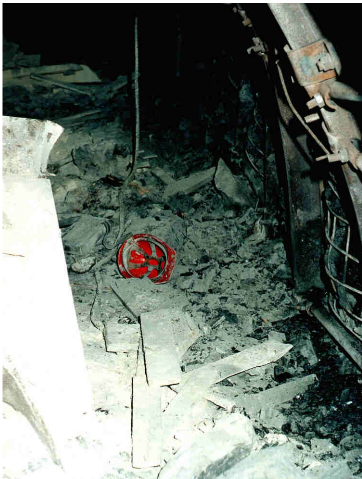
W wyniku tąpnięcia właściciel helmu widocznego na zdjęciu zginął przygnieciony do obudowy. Trzech innych zostało rannych.
