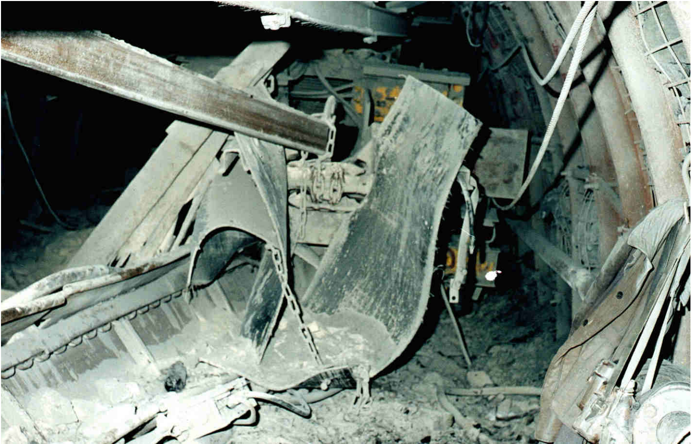
Na zdjęciach skutki tąpnięcia górotworu.
