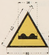
Rys. 1 Wygórowane mostki i poprzeczne ścieki przez drogę
