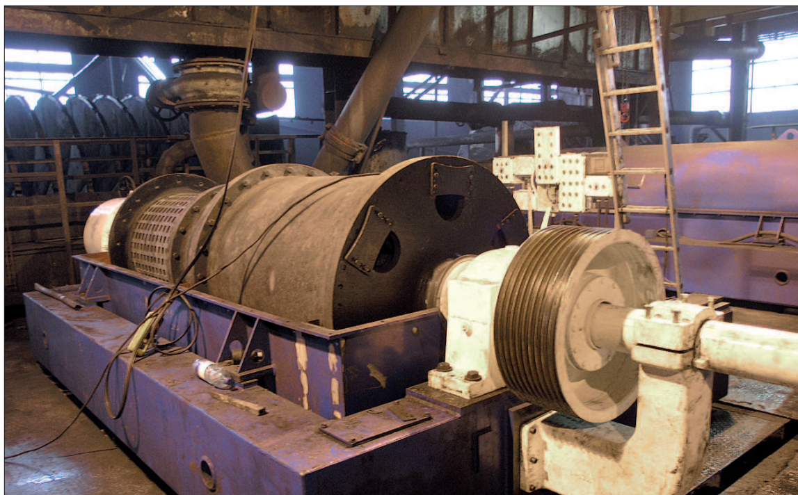
Do odwadniania mokrego węgla służy teraz skuteczna i szybka wirówka.
