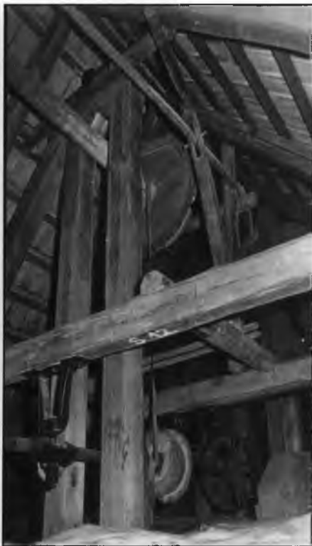
Fragment transmisji na trzeciej kondygnacji młyna (in situ). Fot. B. Weber
