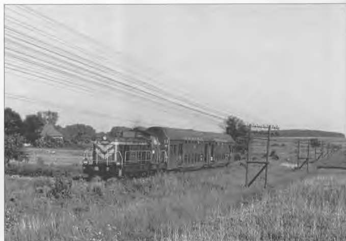
Nietypowy skład: SM42-938 z planowym pociągiem do Głubczyc. 27.07.1996 r. Lokomotywy serii SM42 mogły prowadzić składy pasażerskie jedynie w porze letniej, ponieważ nie były wyposażone w kocioł grzewczy do ogrzewania wagonów. A taki był na standardowym wyposażeniu serii SP42.
