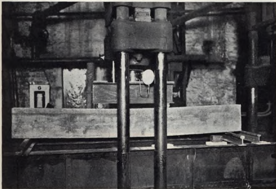
Ryc. 4. Belka na prasie hydraulicznej po złamaniu.
