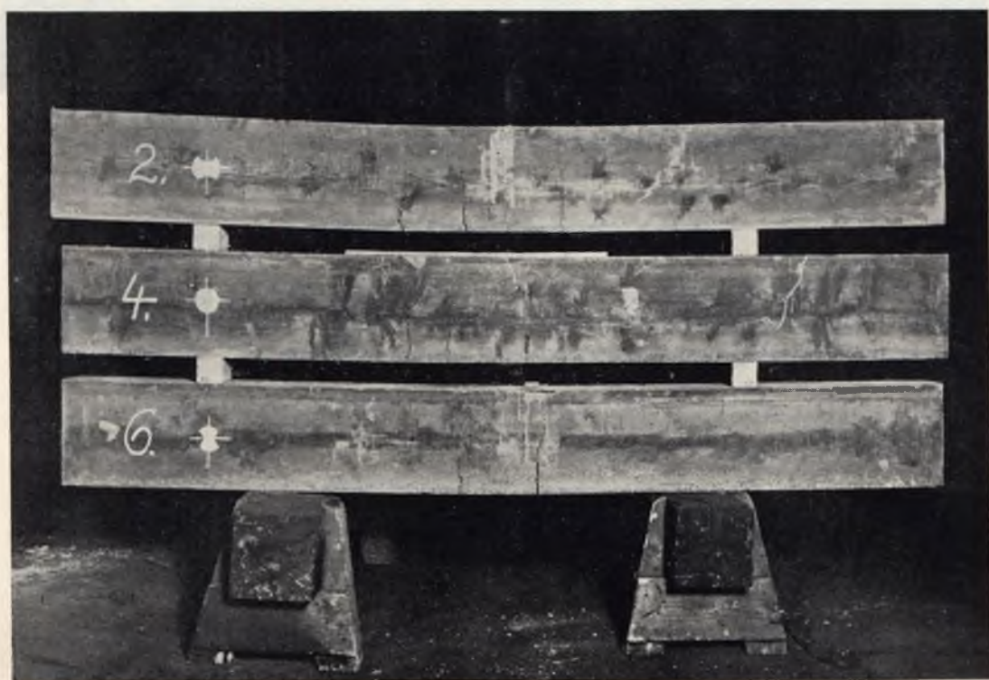
Ryc. 6. Belki Nr. 2, 4 i 6 po złamaniu.
