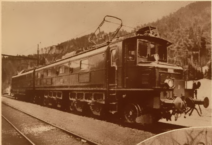
Najsilniejsza lokomotywa świata o napędzie elektrycznym biegnie na linii św. Gotarda w Szwajcarii. Zbudowana przez firmę Brown-Boveri mierzy 24 m długości, waży zaś 365 tonn i może rozwinąć maksymalną szybkość 100 km na godzinę.
