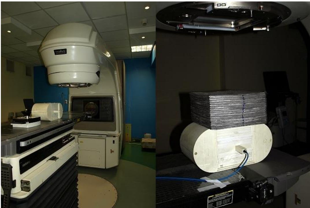
Rysunek 30 Zdjęcia przedstawiające umiejscowienie fantomu I'mRT SCANDITRONIX pod głowicą przyspieszacza Clinac Varian 2300 CD.
