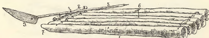
126. Tálba . 1. kragłaki podcięte przy czole 7, a o powiązane w poprzek huźwą; 2. stołek, w jakim porusza się kierma 4, złożona z deski 3 i drugarą 5; 6. świder.
