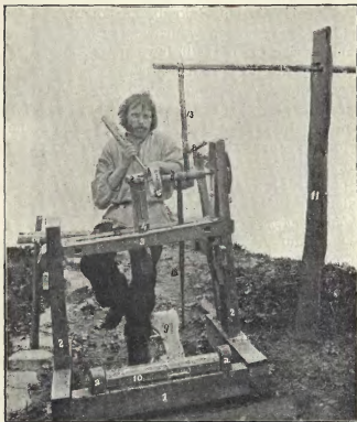
923. Wasył Szkrybłak przy tokarni. 1. Podstawa; 2. 2 słupy; 3. ogniwo — ohnjwo ; 4. zajac ; 5. wałek; 6. materiał przeznaczony do toczenia; 7. reszitec ; 8. krywala ; 9. postil ; 10. worotyło — obracające się w żabkach (a. a.); 11. słup; 12. żerdź; 13. rzemień; 14. siadka.
