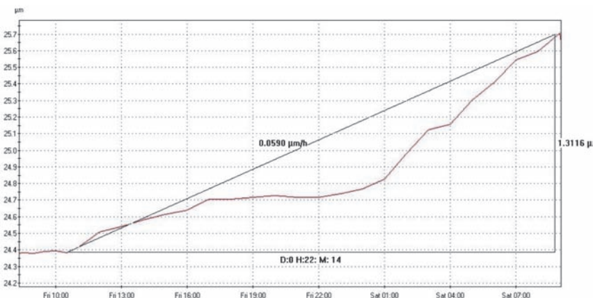
Rys. 8. Wskazania sondy na obiekcie I po zakończeniu dozowania inhibitora 1F (ochrona 24h)
