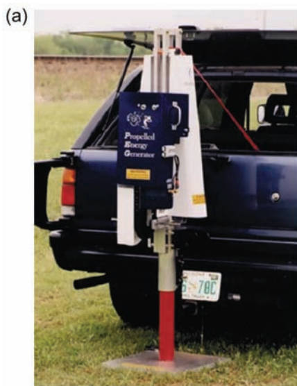
Rys. 5. Przykładowe kafary: Propped Energy Generator produkcji R.T Clark na podstawie [33] – a, ESS100 HM produkcji GISCO na podstawie [31] – b Fig. 5. Examples of weight-drops: Energy Generator Propped- Clark RT, based on [33] (a) and HM ESS100- GISCO, based on [31] (b)
