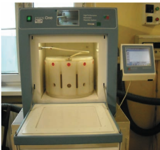
Rys. 1. Mineralizator wielostanowiskowy Ethos One Fig. 1. The mineralizer multiposition Ethos One
