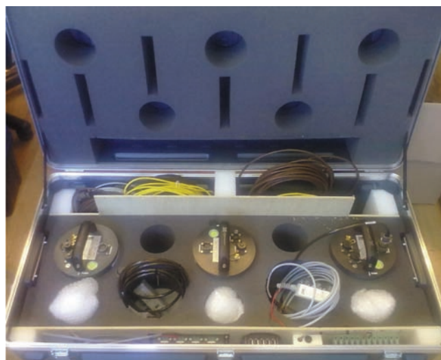
Rys. 3. Zestaw transportowy dla czujników CMG-6TD firmy Güralp [6]
