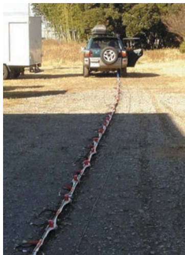
Rys. 3. Taśmowa konstrukcja strimera sejsmicznego LS-1 produkcji Geostuff [24]
