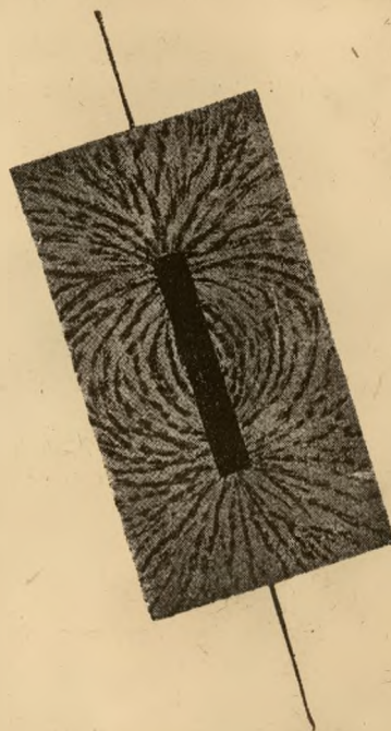
Rys. 4. Żelazne opiłki w pobliżu magnesu układają się wzdłuż linii pola magnetycznego
