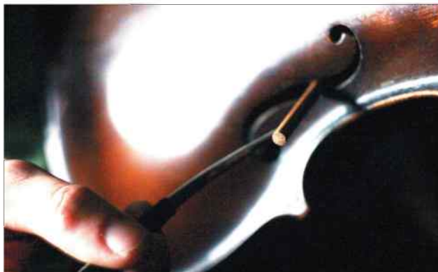
Duszę do instrumentu wkłada się za pomocą duszostawiacza
