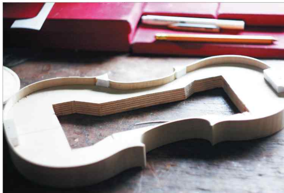
Wykonanie skrzypiec zaczyna się od wygięcia boczków
