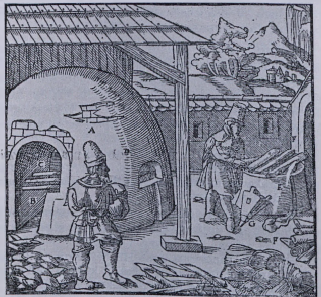
Rys. 11. Polski i węgierski piec do wypalania ołowiu według Agricoli. A — piec na kształt piekarskiego, B — uliczka, C — ruszt żelazny, D — otwór roboczy, przez który spuszcza się glejte, E — trzon bez pokrywy, F — grube bierwiona drzewa, G — miech.
