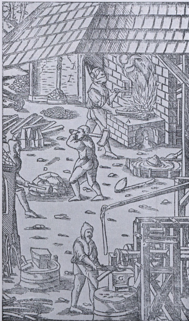
Rys. 9. Wytwarzanie żelaza na ognisku według Agricoli. A — trzon, B — przygotowany stos, C — odpływ żużla, D — bochny żelaza, E — młoty drewniane, F — wielki młot żelazny, G — kowadło.
