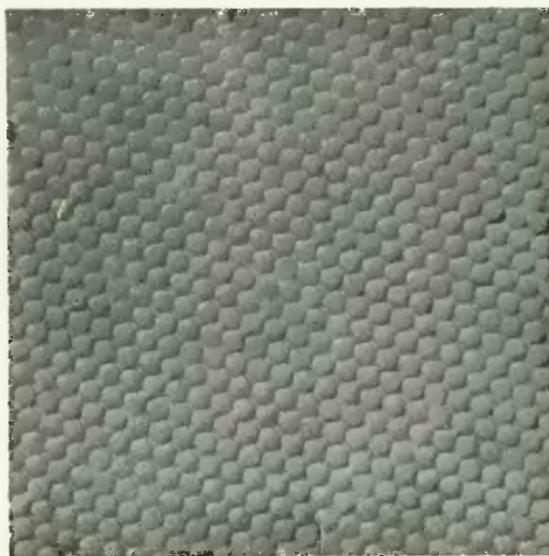
Fig. 3. — Agrandissement d'un fragment de millimètre carré d'une pellicule pour cinéma en couleurs montrant le réseau de lentilles disposées en « nids d'abeilles ».
