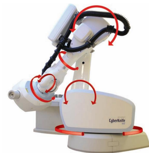
Rysunek 7. CyberKnife – stopnie swobody [34].
