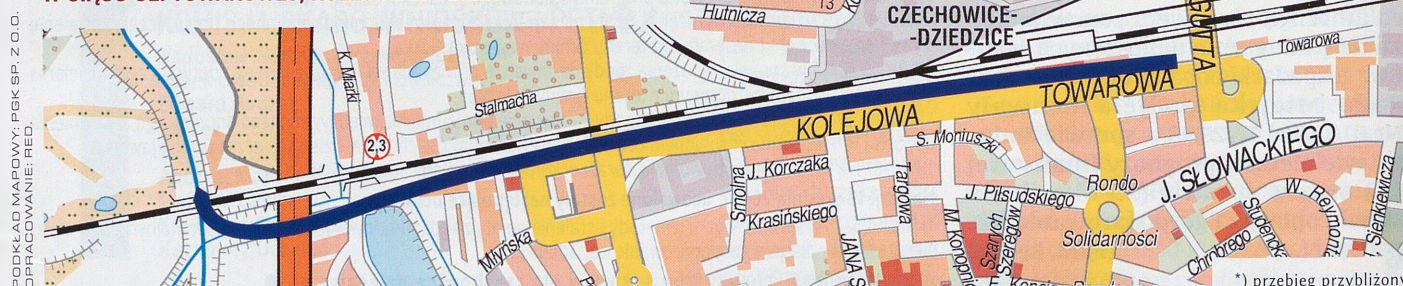
PLANOWANY, WSTĘPNY PRZEBIEG KOLEKTORA DESZCZOWEGO W CIĄGU UL. TOWAROWEJ, KOLEJOWEJ I ZIELONEJ*
