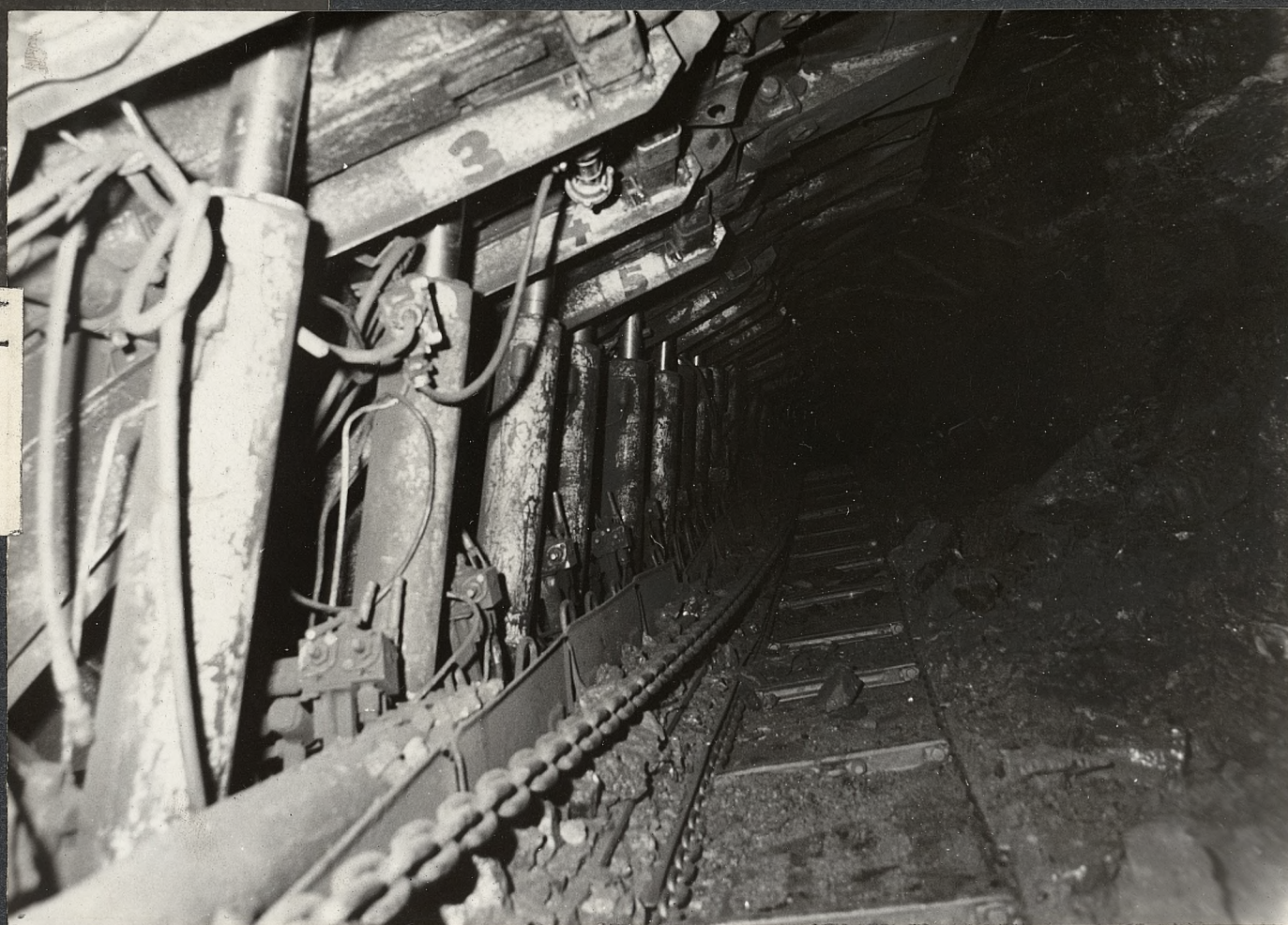
Obudowa ścianowa, zmechanizowana typem OKP z przenośnikiem i kombajnem KS2-1KG
