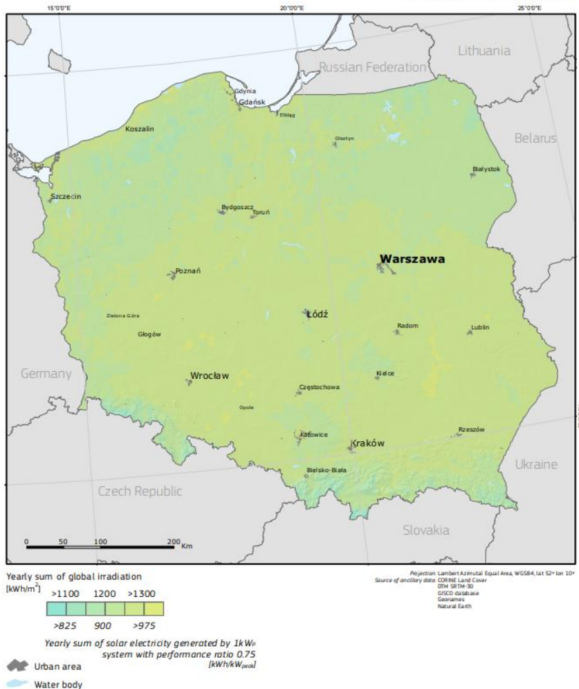
Rys. 3.9 Globalne nastonecznienie dla obszaru Polski - dane dla absorbera (modułów) o optymalnej orientacji względem promieniowania słonecznego 20
