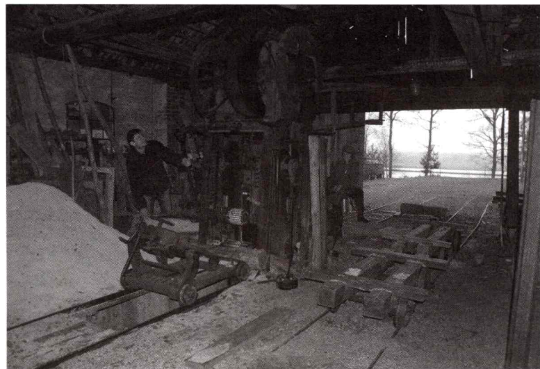
Tartak Drzymałów napędzany turbiną wodną.
